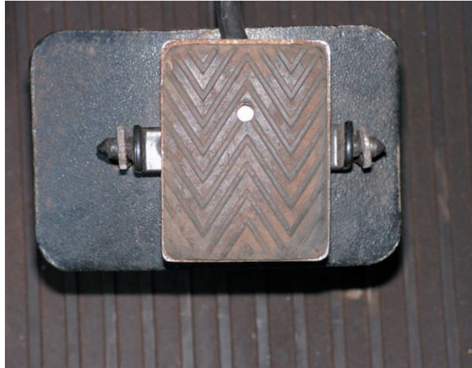
Rys. 5. Czujnik siły nacisku na pedale hamulca Fig. 5. Force sensor on braking pedal
