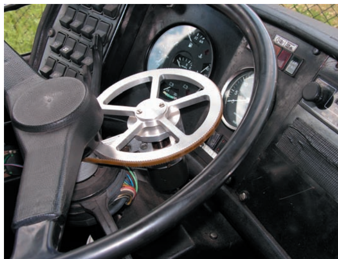
Rys. 4. Kierownica z zamontowanym czujnikiem kąta obrotu Fig. 4. Steering wheel and rotational sensor
