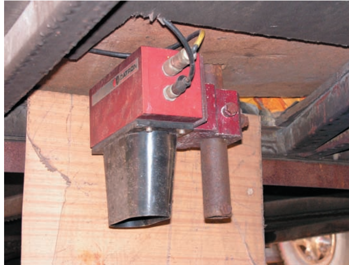
Rys. 2. Czujnik przemieszczenia wzdłużnego pojazdu Fig. 2. Sensor of longitudinal displacement
